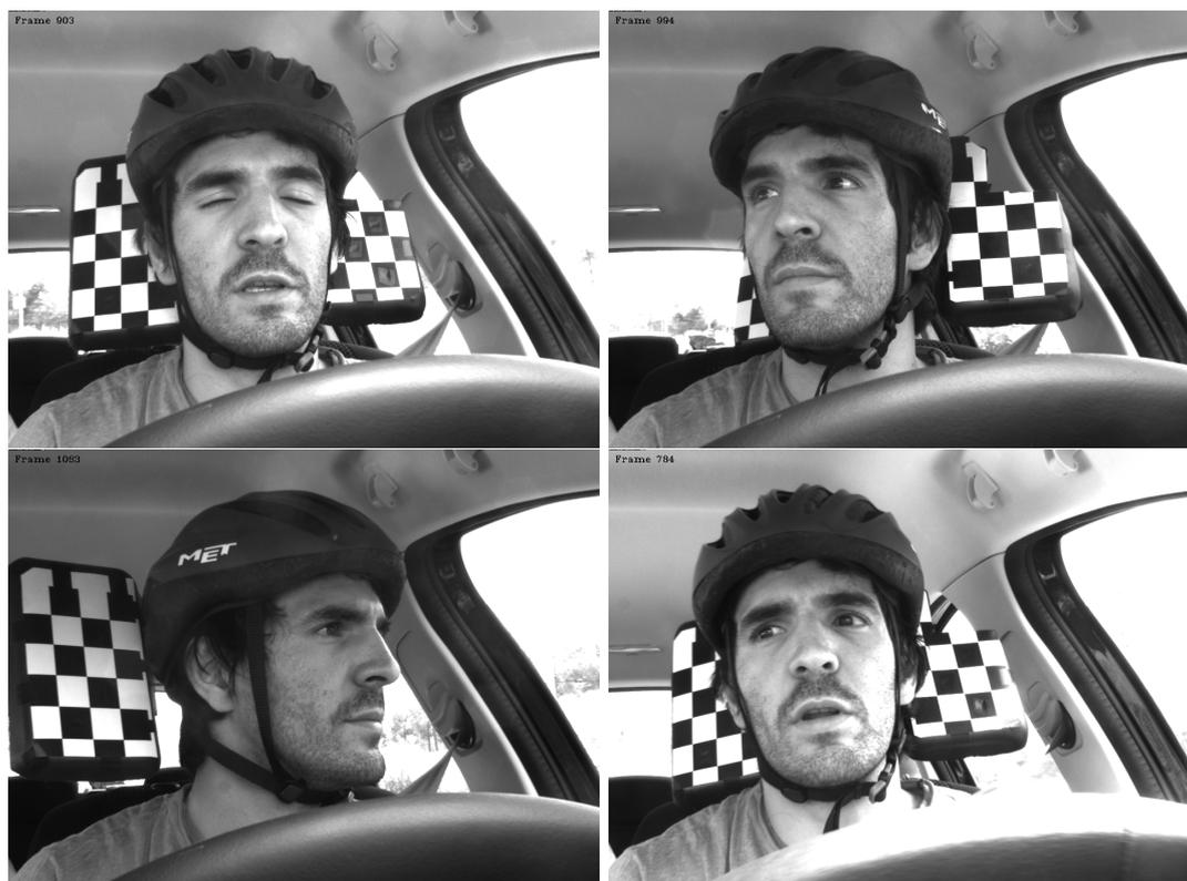
Figura 5.2: Ejemplos del casco con damero utilizado para la calibración
