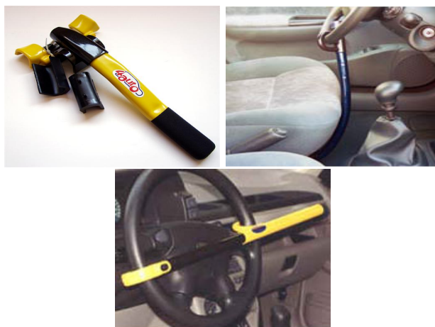
Figura 2.2: Dispositivos antirrobo mecánicos que bloquean volante con cuadro de mandos o volante con asiento
