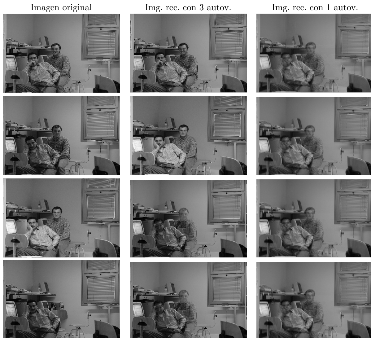
Figura 3.20: Ejemplos de recuperación de las imágenes con 3 y con 1 autovector con PCA
