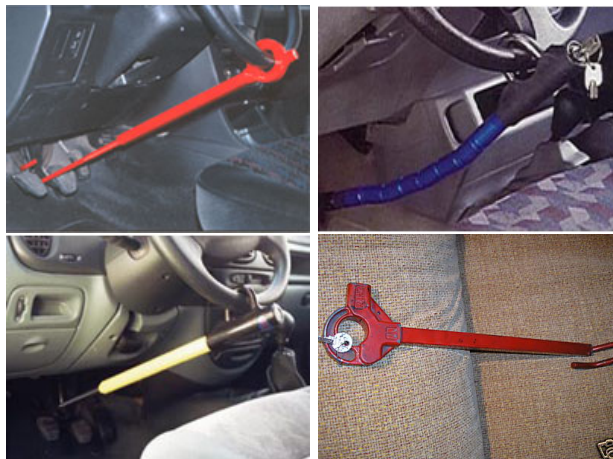
Figura 2.1: Sistemas antirrobo mecánicos que bloquean pedales y volante
