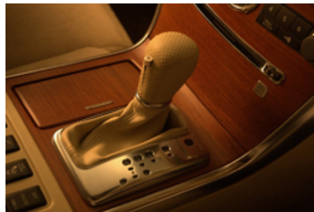
Figura 2.13: Sensor de alcohol en el sudor situado en la palanca de cambios
