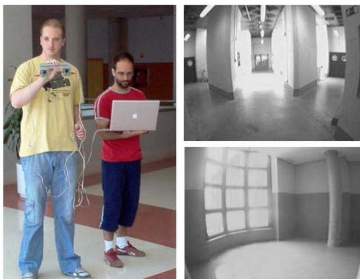
Fig. 2. Sistema de visión estéreo utilizado 6DOF SLAM y entorno de pruebas experimentales
